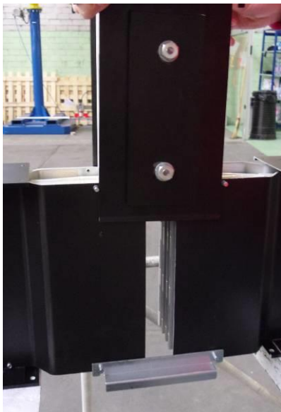
Inserire il giunto monobullone.... Insérer le joint monobloc.... Insert the monoblock joint....
