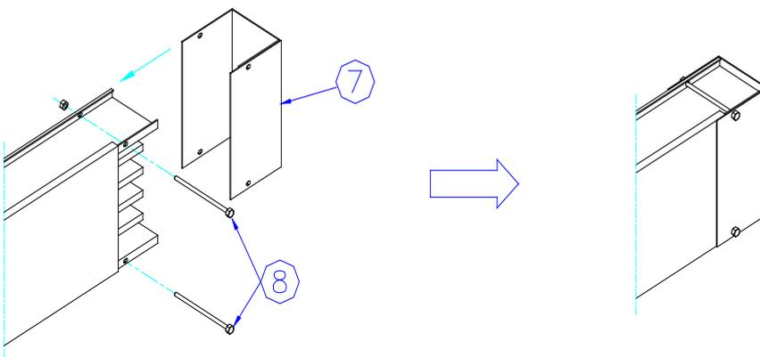
g) Placer l'embout de fermeture (7) et fermer les deux vis traversantes (8).
