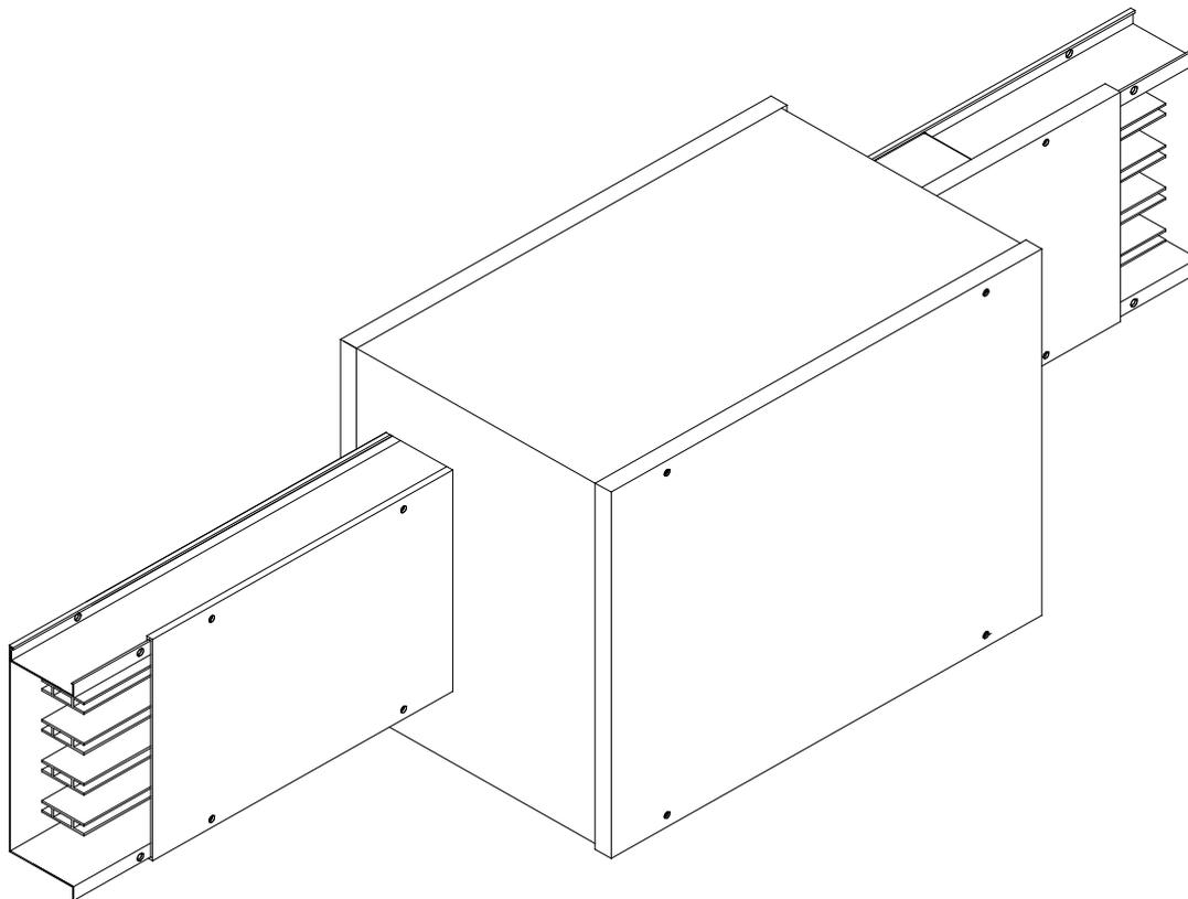
ATTENTION : Percer le coffret avant de le monter sur la ligne, en la prédisposant pour le passage des câbles.
