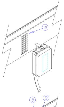
f) Accrocher les deux crochets (5) au bord de la barre GDA en vérifiant l'insertion des dents pour le crochet. Bloquer les vis (9) au corps du coffret (7).
