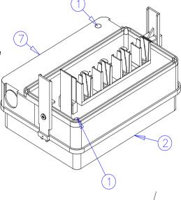
e) Insérer le coffret dans la dérivation (10) placée sur la barre GDA, tout en vérifiant la correspondance entre PE et la glissière qui permet l'ouverture de la porte.
