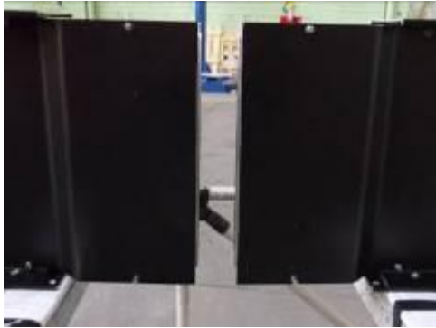
Avvicinare i terminali di 4 cm... Rapprocher les terminaux de 4 cm... Bringing terminals 4 cm...
